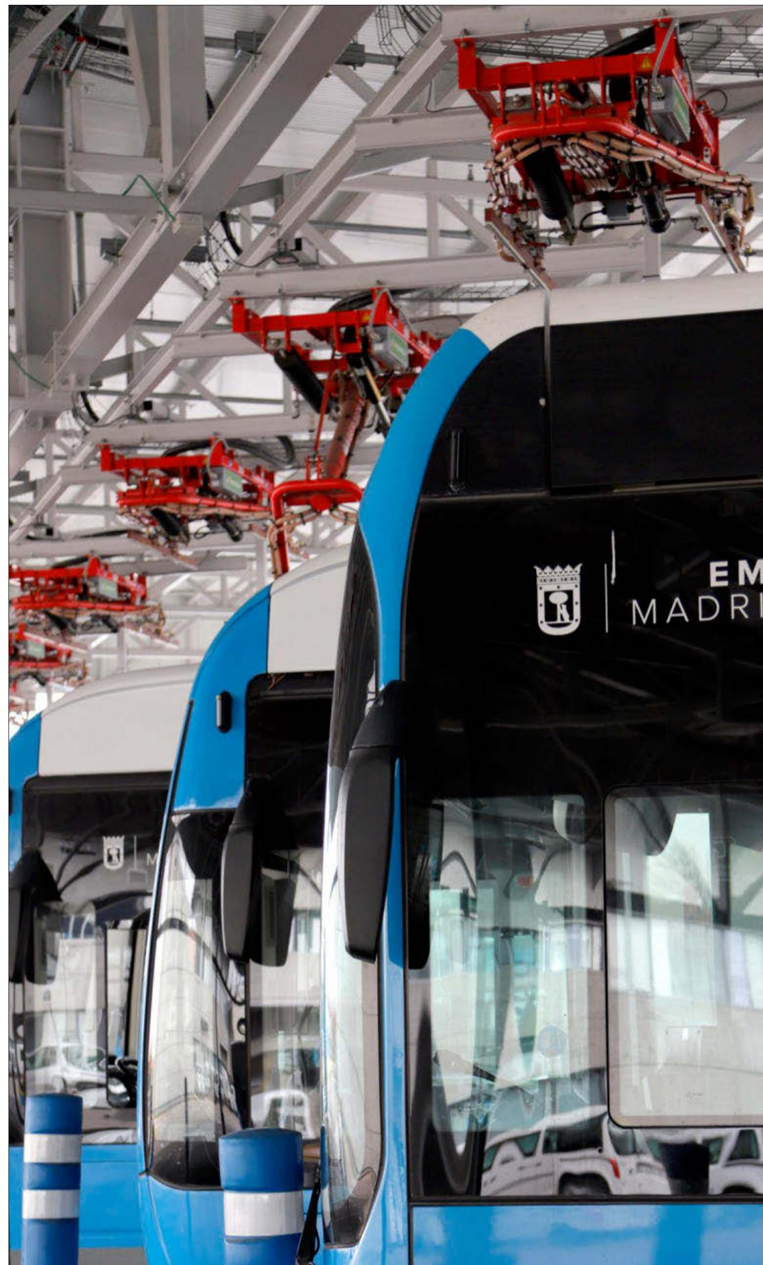
Varios autobuses eléctricos, ayer, en proceso de carga con los pantógrafos invertidos. E. M.
